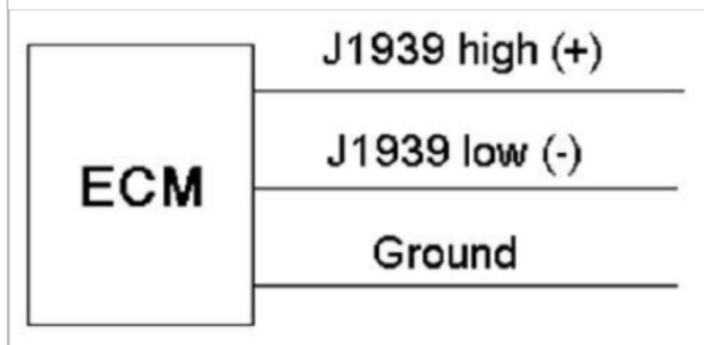
250K 波特率时，在 J1939 高、低导线间的电压从 0 到 1 每秒变化 250K 次是可能的。用一个高频示波器可以看到此电压变化。
