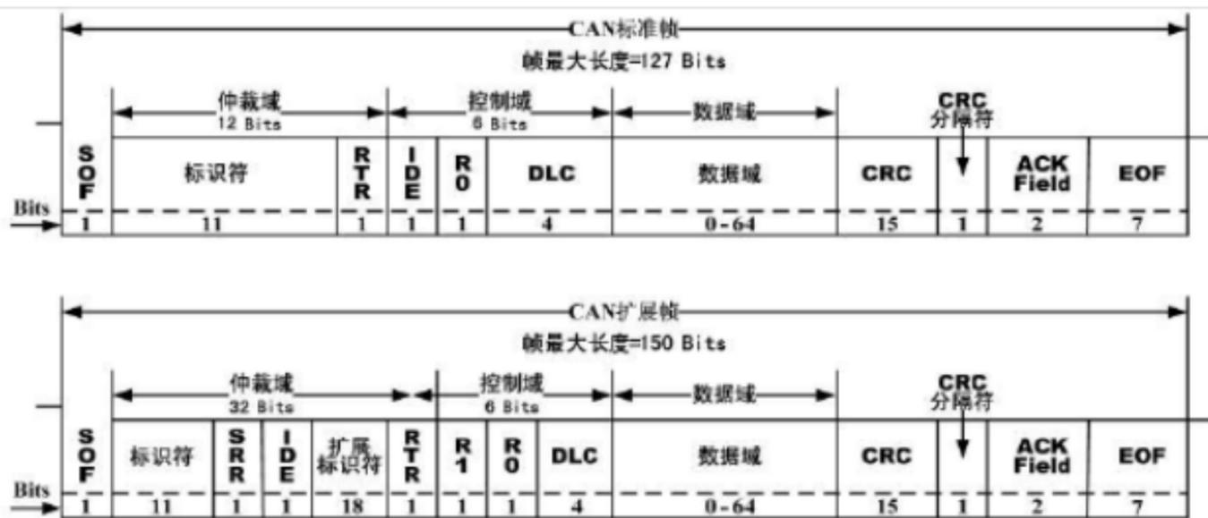
CAN数据帧组成: 帧起始 (SOF)、仲裁域、控制域、数据域、循环冗余校验域 (CRC)、应答域 (ACK)、帧结束 (EOF)。
