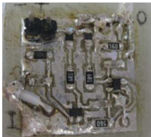
图 6-2-6 脉冲产生电路实际制作
