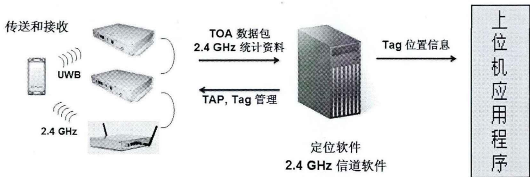
图 2-10 PLUS 定位系统工作原理
